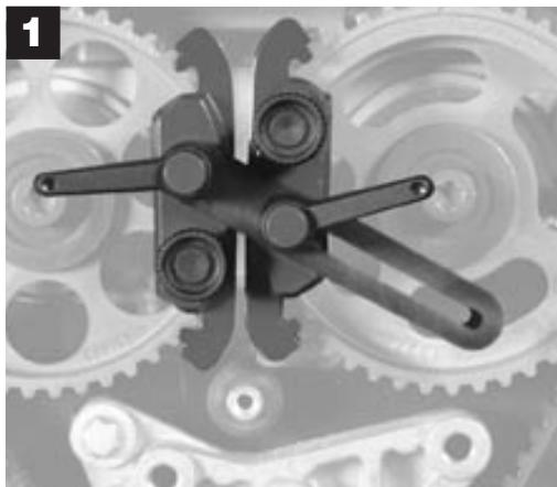
**I****Dispositivo di bloccaggio della ruote dentate**
