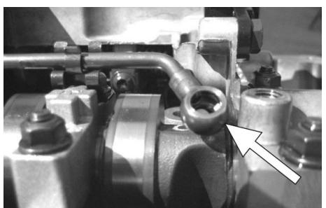
Débrancher le connecteur de l'actionneur de l'arbre à cames d'aspiration. Enlever la goupille de sécurité (relative à la vis inférieure du guide de la chaîne); dévisser puis enlever la vis du guide de la chaîne.
