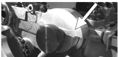
Plaats gereedschap D816 aan de voorkant van de inlaatnokkenas en verzekert u ervan dat hij helemaal op de "rand" van de kop ligt. Bevestig hem met volledig aangedraaide borgschroef op de nokkenas.
