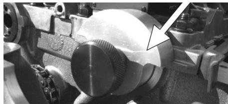
Placer l'outil D816 à la partie avant de l'arbre à cames d'aspiration, en veillant à ce qu'il appuie complètement sur le 'bord' de la culasse, puis le fixer avec la vis de blocage complètement vissée sur l'arbre à cames.
