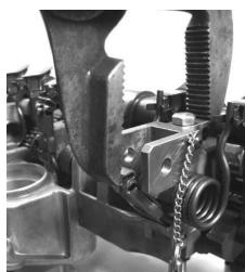
Desserrer lentement la pince de façon à relâcher la pression du ressort de torsion. Enlever le ressort de torsion ainsi que le crochet D818 et le culbuteur (ne pas oublier de marquer la position de celui-ci). Répéter la même procédure pour enlever les autres ressorts.
