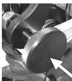
**IMPORTANT: les culbuteurs doivent être remplacés dans la même position où ils se trouvaient. Installer les culbuteurs un à la fois, en les fixant tous avec les crochets D818.**
