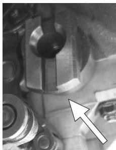
**IMPORTANTE: Al momento dell'installazione dell'albero a camme d'aspirazione, il profilo curvo sul retro dell'albero a camme deve essere rivolto verso il basso, in modo che l'albero a camme si trovi nella posizione corretta quando il supporto viene installato sulla testata.**
