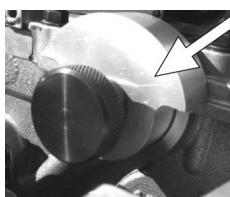
Fixar as ferramentas D816 e D817 de forma que cada extremidade da árvore de cames de aspiração esteja fixada no suporte. Lubrificar os balancins com óleo de motor e executar a instalação.
