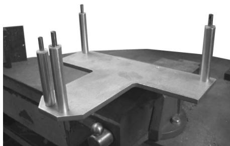
Montar a ferramenta e bloquear a mesma com uma morsa adequada.
