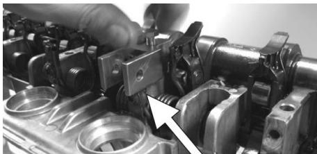
Das Werkzeug D814 mit dem vorgesehenen Bolzen auf dem Lager positionieren. Die Mutter ist dabei unter dem Lager positioniert.
