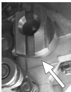
**IMPORTANTE:** Cuando está instalando el árbol de levas de admisión, el perfil curvado en la parte trasera del árbol de levas ha de estar dirigido hacia abajo, de manera que el árbol de levas se encuentre en la posición correcta cuando el soporte se instala en la culata.
