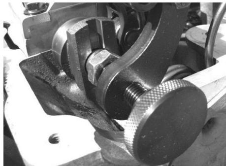
Placer l'outil D817 à l'arrière de l'arbre à cames d'aspiration en vissant le boulon de blocage correspondant sur le filetage de l'arbre excentrique (serrer tout d'abord manuellement). Placer l'écrou à tête ronde au centre de la rainure centrale de l'arbre à cames. Serrer manuellement la vis avec l'écrou à tête ronde afin de 'blocker' l'outil sur l'arbre à cames. Serrer le boulon de blocage sur l'arbre excentrique.
