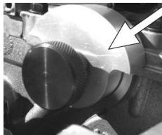
Fije las herramientas D816 y D817 de manera que cada extremo del árbol de levas de admisión esté fijado en el soporte. Lubrique los empujadores de leva con aceite motor y siga con la instalación.
