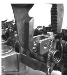
Rilasciare la pinza lentamente in modo da scaricare la molla di torsione. Rimuovere la molla di torsione insieme al gancio D818 e al bilanciere (ricordarsi di segnare la posizione del medesimo). Ripetere la procedura per rimuovere le restanti molle.
