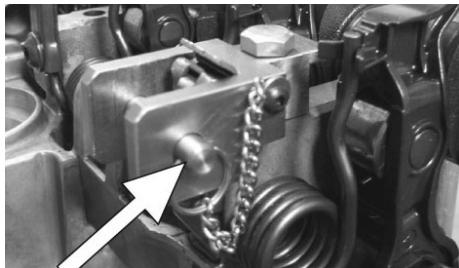
Introduzca completamente la clavija de seguridad. La clavija de seguridad retendrá el resorte de torsión, una vez retirado el tornillo que lo bloquea.
