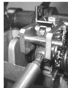
Retire los alicates y enrosque el tornillo que fija el resorte.
