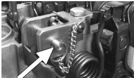
Doe de veiligheidspin er helemaal in. De veiligheidspin houdt de torsieveer vast als de schroef is verwijderd die hem vastzet.
