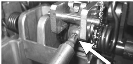
Draai de schroef die de klepveer vasthoudt langzaam los en verwijder hem zodanig dat de plaat van de veer tegen de veiligheidspin aankomt.
