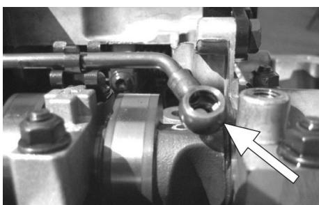
Staccare il connettore dell'attuatore dell'albero a camme d'aspirazione. Rimuovere la spina di sicurezza (relativa alla vite inferiore della guida della catena); svitare ed rimuovere la vite della guida della catena.
