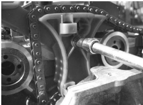
Svitare ed rimuovere la vite superiore della guida della catena ed rimuovere la guida.
