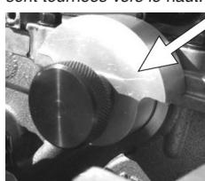
Fixer les outils D816 et D817 de façon à ce que chaque extrémité de l'arbre à cames d'aspiration soit fixée au support. Lubrifier les culbuteurs avec de l'huile moteur et procéder à leur installation.
