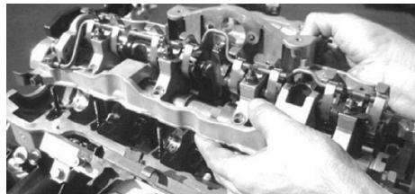
Poursuivre l'opération de démontage en extrayant avec précaution le groupe arbre à cames/support hors de la culasse.
