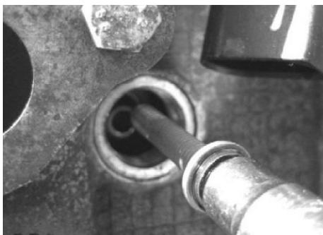
Den Verbinder des Einlassnockenwellentriebs trennen. Den Scherstift (bezüglich der unteren Schraube der Kettenführung) entfernen; die Schraube der Kettenführung losschrauben und entfernen.
