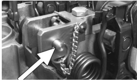
Den Sicherheitsdorn vollständig einsetzen. Der Sicherheitsdorn hält die Torsionsfeder, nachdem die Schraube, die diese blockiert, herausgezogen wurde.
