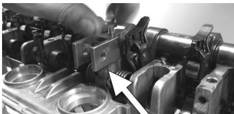
Fije la D814 al soporte con el perno destinado al efecto, con la tuerca colocada bajo el soporte.
