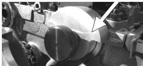
Posicionar a ferramenta D816 na parte dianteira da árvore de cames de aspiração, verificando que apoie totalmente na 'beirada' da cabeça, e fixar a mesma com o parafuso de bloqueio totalmente aparafusado na árvore de cames.
