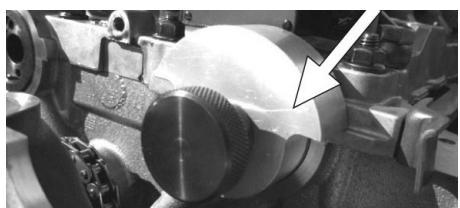
Das Werkzeug D816 am vorderen Teil der Einlassnockenwelle positionieren und sicherstellen, dass es vollständig auf dem Zylinderkopfrand aufliegt. Anschließend das Werkzeug mit der vollständig auf der Nockenwelle festgezogenen Befestigungsschraube befestigen.
