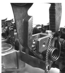
Laat de pin langzaam los om de torsieveer te ontspannen. Verwijder de klepveer samen met haak D818 en de balanshefboom (denk eraan dat u de plaats ervan markeer). Herhaal de procedure om de andere veren te verwijderen.
