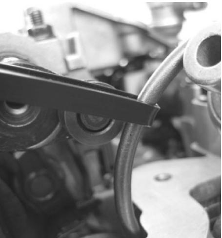
Die Exzenterwelle mit Hilfe des Sechskants drehen, um die Spannung auf der Torsionsfeder zu verringern. Eine Zugstange an der Feder befestigen und diese leicht zurückziehen, um sie somit von der Rolle zu nehmen. Dann die Feder zur Spannungslockerung langsam über die Rolle hinaus nach vorn rücken lassen, **WICHTIG: die Exzenterwelle bis zur Mindesthubposition drehen - vollständig im Uhrzeigersinn drehen.**
