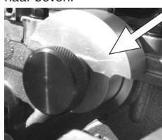
Bevestig het gereedschap D816 en D817 zodanig dat ieder uiteinde van de inlaatnokkenas aan de steun is bevestigd. Smeer de balanshefbomen met motorolie en installeer ze.
