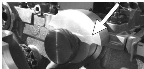
Posizionare l'attrezzo D816 alla parte anteriore dell'albero a camme d'aspirazione, assicurandosi che poggi completamente sul 'bordo' della testata, e fissarlo con la vite di bloccaggio completamente avvitata sull'albero a camme.
