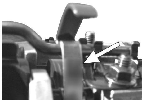
Utiliser les 8 crochets fournis. Fixer les crochets à la partie inférieure des culbuteurs puis fixer la partie supérieure au tuyau de refoulement de l'huile.
