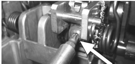
Svitare lentamente ed rimuovere la vite che trattiene la molla di torsione in modo che la piastra della molla vada in battuta sulla spina di sicurezza.
