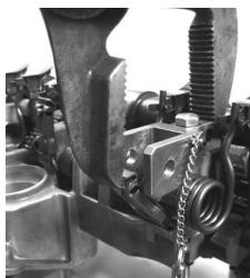
Suelte los alicates lentamente para descargar el resorte de torsión. Retire el resorte de torsión junto al gancho D818 y al empujador de leva (recuerde que ha de marcar la posición del mismo). Repita el procedimiento para retirar los otros resortes.
