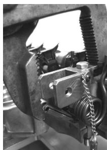
Die Spannbacken der Zange langsam spannen und somit die Feder zusammendrücken. Den Sicherheitsdorn einsetzen.
