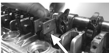
Fixar o D814 no suporte com o parafuso apropriado com a porca posicionada sob o suporte.
