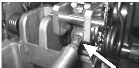
Desparafusar devagar e remover o parafuso que retém a mola de torção de forma que a placa da mola vá em batente sobre o pino de segurança.
