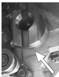
**BELANGRIJK:** Bij de installatie van de inlaatnokkenas moet het gebogen profiel aan de achterkant van de nokkenas naar onderen gedraaid zijn, zodat de nokkenas zich op de juiste stand bevindt als de steun op de kop wordt geïnstalleerd.
