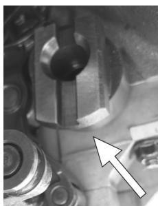
**WICHTIG:** beim Einbau der Einlassnockenwelle muss das gekrümmte Profil auf der Rückseite der Nockenwelle nach unten gerichtet sein, damit die Nockenwelle beim Einbau des Lagers auf dem Zylinderkopf korrekt positioniert ist.
