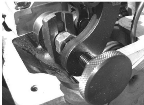
Posizionare l'attrezzo D817 sul retro dell'albero a camme d'aspirazione avvitando il relativo bullone di bloccaggio nel filetto dell'albero eccentrico (inizialmente serrare solo manualmente). Collocare il dado a testa tonda al centro della scanalatura centrale dell'albero a camme. Serrare manualmente la vite con il dado a testa tonda, per 'bloccare' l'attrezzo sull'albero a camme. Serrare il bullone di bloccaggio sull'albero eccentrico.
