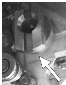
**IMPORTANT: au moment de l'installation de l'arbre à cames d'aspiration, le profil courbe à l'arrière de l'arbre à cames doit être orienté vers le bas afin que l'arbre à cames se trouve dans la bonne position lorsque le support est installé sur la culasse.**
