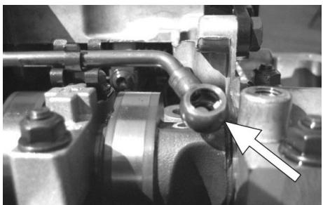
Verwijder de connector van de aandrijver van de inlaatnokkenas. Verwijder de veiligheidsstekker (die bij de schroef aan de onderkant van de kettinggeleiding hoort). Draai de schroef van de kettinggeleiding los en verwijder hem.
