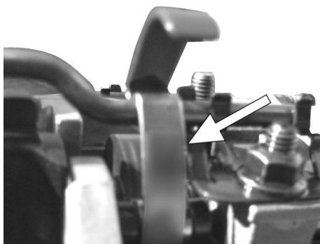
Devono essere utilizzati tutti gli 8 ganci in dotazione. Fissare i ganci alla parte inferiore dei bilancieri; quindi fissare la parte superiore al tubo di mandata dell'olio.
