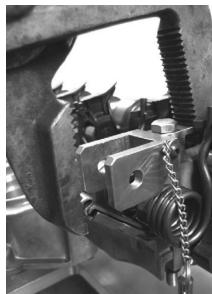
Apriete lentamente las bocas de los alicates para comprimir el resorte e introduzca la clavija de seguridad.
