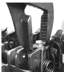
Apriete ligeramente los alicates y retire la clavija de seguridad.
