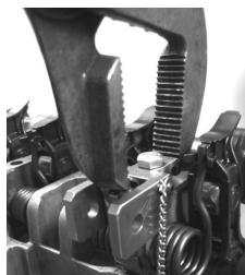
Die Zange leicht spannen und den Sicherheitsdorn entfernen.
