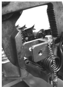
Stringere lentamente le ganasce della pinza per comprimere la molla e inserire la spina di sicurezza.
