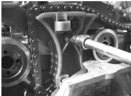
Die obere Schraube der Kettenführung lösen und entfernen. Anschließend die Führung entfernen.
