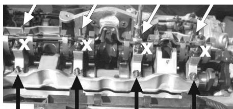
Prestar atenção nas porcas que devem ser desparafusadas para a remoção do CONJUNTO DA ÁRVORE DE CAMES/SUPORTE.
