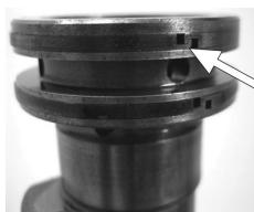
**Árvore de cames de aspiração** - Verificar sempre a condição dos anéis de retenção da árvore de cames, pois podem quebrar com facilidade. Para a instalação, desmontar os anéis com cuidado e introduzi-los na parte dianteira da árvore. Comprimir o anel para enganchar o retentor.
