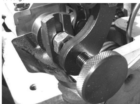
Das Werkzeug D817 auf der Rückseite der Einlassnockenwelle positionieren und den zugehörigen Sperrbolzen im Gewinde der Exzenterwelle festschrauben (anfangs nur von Hand anziehen). Die Rundmutter in der Mitte der mittigen Nockenwellennut setzen. Die Schraube mit Rundmutter von Hand anziehen, um das Werkzeug an der Nockenwellen zu befestigen. Den Befestigungsbolzen auf der Exzenterwelle anziehen.
