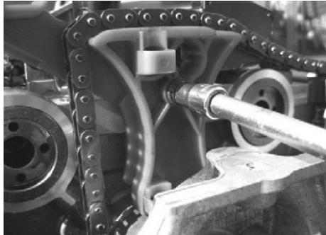
Desenrosque y retire el tornillo superior de la guía de la cadena y retire la guía.
