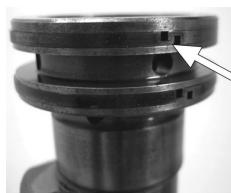
**Arbre à cames d'aspiration - Vérifier toujours l'état des bagues de retenue de l'arbre à cames car elles peuvent facilement se casser. Pour l'installation, démonter les bagues avec précaution et les introduire sur la partie**
