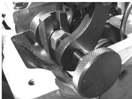
Coloque la herramienta D817 en la parte trasera del árbol de levas de admisión enroscando el perno de bloqueo correspondiente en la rosca del árbol excéntrico (al principio apriete tan sólo manualmente). Coloque la tuerca de cabeza redonda en el centro del canal central del árbol de levas. Apriete manualmente el tornillo con la tuerca de cabeza redonda, para 'bloquear' la herramienta en el árbol de levas. Apriete la tuerca de bloqueo en el árbol excéntrico.
