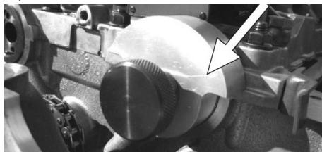
Coloque la herramienta D816 en la parte delantera del árbol de levas de admisión, asegurándose de que esté apoyada completamente sobre el 'borde' de la culata, y fíjela con el tornillo de bloqueo completamente enroscado en el árbol de levas.
