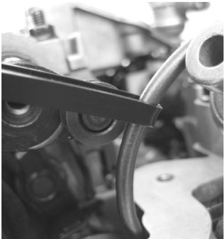
Rodar o eixo excêntrico por meio do hexágono, para reduzir a tensão na mola de torção.
