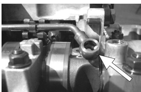
Desenrosque y retire el perno de conexión del tubo de alimentación del aceite (árbol de levas de escape). De esta manera, el tubo puede retroceder y desplazarse una vez retirado el grupo de patrones de ensamblaje del árbol de levas.
