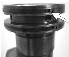
**Árbol de levas de admisión** - Compruebe siempre la condición de los anillos de retención del árbol de levas, porque pueden romperse con facilidad. Para la instalación, desmonte los anillos con atención e introduzcalos en la parte
