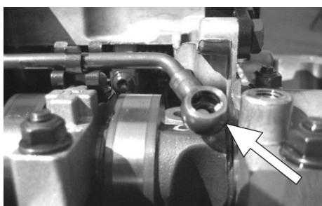
Desprender o conector do actuador da árvore de cames de aspiração. Remover o pino de segurança (relativo ao parafuso inferior da guia da corrente); desparafusar e remover o parafuso da guia da corrente.
