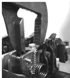
Mit Hilfe der einstellbaren Zange die Feder und das Werkzeug D814 greifen.
