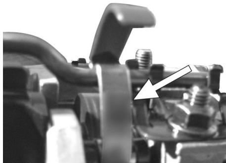
Devem ser utilizados todos os 8 ganchos fornecidos. Fixar os ganchos à parte inferior dos balancins; depois fixar a parte superior ao tubo de vazão do óleo.
