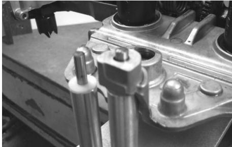
Das Lager auf den auf den Säulenspitzen befindlichen Dornen positionieren.
