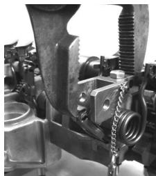
Die Zange langsam lösen, um die Torsionsfeder zu entspannen. Die Torsionsfeder zusammen mit dem Haken D818 und dem Kiphebel entfernen (nicht vergessen, dessen Position zu kennzeichnen). Den Vorgang wiederholen, um die übrigen Federn zu entfernen.
