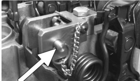
Inserire completamente la spina di sicurezza. La spina di sicurezza tratterrà la molla di torsione, una volta estraetta la vite che la blocca.
