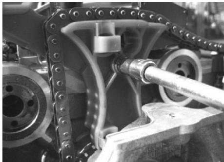
Desparafusar e remover o parafuso superior da guia da corrente e remover a guia.
