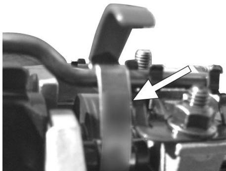
Alle 8 im Lieferumfang enthaltenen Haken sind zu verwenden. Die Haken unten an den Kipphebeln befestigen. Dann den oberen Teil an der Öldruckleitung befestigen.
