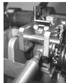
Die Zange entfernen und die zur Fixierung der Feder verwendete Schraube festschrauben.
