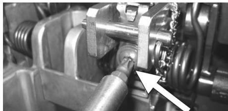
Die Schraube, die die Torsionsfeder hält, langsam losschrauben und entfernen, so dass die Federplatte auf dem Sicherheitsdorn anschlägt.
