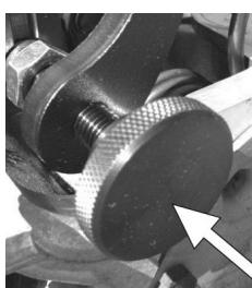
**IMPORTANTE** Los empujadores de leva han de volverse a utilizar en la misma posición de la que se han retirado. Coloque los empujadores de leva uno a la vez, fijándolos todos con los ganchos D818.
