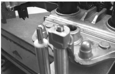
Coloque el soporte en las clavijas situadas en el extremo de las columnas.
