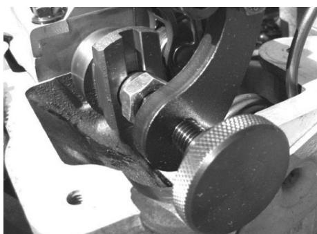
Plaats gereedschap D817 op de achterkant van de inlaatnokkenas en schroef de bijbehorende borgbout in de Schroefdraad van de excentrische as (draai de moer aanvankelijk alleen met de hand aan). Plaats de moer met ronde kop in het midden van de uitsparing in het midden van de nokkenas. Draai de schroef met de hand met de moer met ronde kop aan, om het gereedschap op de nokkenas "vast te zetten". Zet de borgbout op de excentrische as vast.
