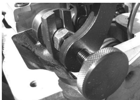
Posicionar a ferramenta D817 na parte traseira da árvore de cames de aspiração aparafusando o relativo parafuso de bloqueio na rosca do eixo excêntrico (initialmente apertar somente manualmente). Colocar a porca de cabeça redonda no centro da fenda central da árvore de cames. Apertar manualmente o parafuso com a porca de cabeça redonda, para 'bloquear' a ferramenta na árvore de cames. Apertar o parafuso de bloqueio no eixo excêntrico.
