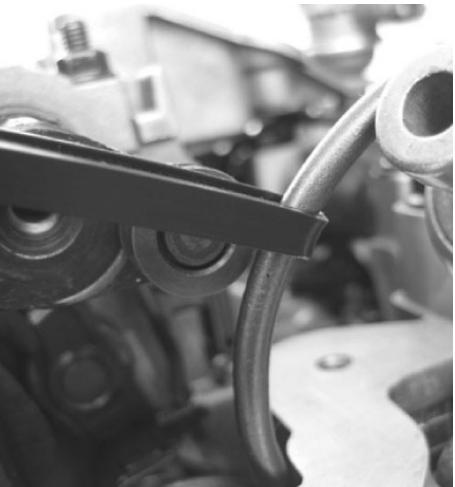
Ruotare l'albero eccentrico tramite l'esagono, per ridurre la tensione sulla molla di torsione.
