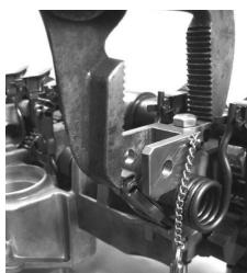
Soltar o alicate devagar de forma a descarregar a mola de torção. Remover a mola de torção junto com o gancho D818 e o balancim (lembra de marcar a posição do mesmo). Repetir o procedimento para remover as molas restantes.
