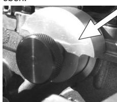
Die Werkzeuge D816 und D817 so fixieren, dass jedes Einlassnockenwellenende am Lager gefestigt ist.
