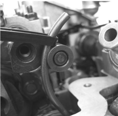
Tourner l'arbre excentrique à l'aide du six pans creux afin de diminuer la tension sur le ressort de torsion. Fixer un tirant au ressort puis le reculer légèrement pour l'enlever du rouleau; faire ensuite avancer lentement le ressort, au-delà du rouleau, afin de diminuer la tension.
