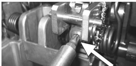
Desenrosque lentamente y retire el tornillo que retiene el resorte de torsión de manera que la placa del resorte golpee la clavija de seguridad.
